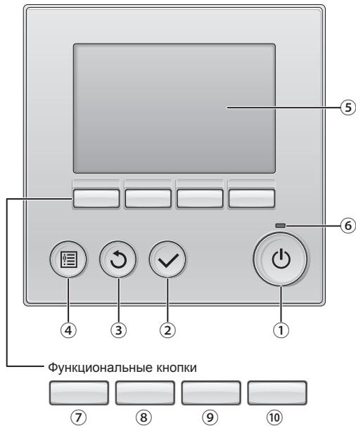
Функции функциональных кнопок меняются в зависимости от экрана. См. подсказку по функциям кнопок, которая отображается в нижней части ЖК-экрана для функций, которые работают в данном окне.
