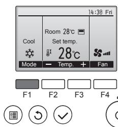
Нажмите кнопку [F1] для перехода между режимами работы в порядке "Cool" (Охлажд.), "Dry" (Сушка), "Fan" (Вент.), "Auto" (Авт.) и "Heat" (Нагрев). Выберите желаемый режим работы.
