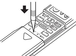
Нажмите кнопку Reset (Сброс) с помощью объекта с узким концом.
