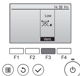
Нажмите кнопку [F3] для перехода между вариантами настройки вентиляции в следующем порядке: "Off" (Выкл), "Low" (Низ.) и "High" (Выс.).
