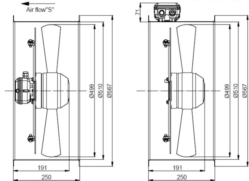
AXW S - осевой вытяжной вентилятор на монтажной панели с защитной решеткой
