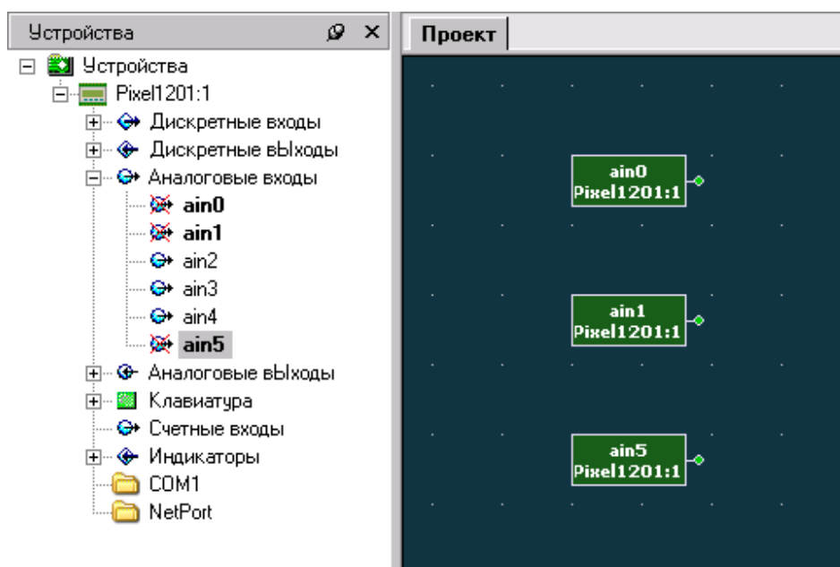
Рисунок 54. Использование аналоговых входов в «SMLogix»
