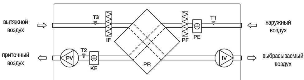
Pv – вентилятор приточного воздуха, IV – вентилятор вытяжного воздуха, RP – пластинчатый рекуператор «Sensitive», PE – предварительный электрический нагреватель, KE – основной электрический нагреватель, PF – фильтр наружного воздуха, IF – фильтр для вытяжного воздуха, T1 – датчик температуры наружного воздуха, T2 – датчик температуры приточного воздуха, T3 – датчик температуры вытяжного воздуха.
