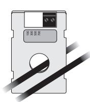
Два витка кабеля одной и той фазы
