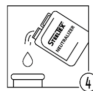
Шаг 4 - Нейтрализация кислотности теплообменника
