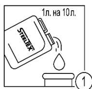
Шаг 1 - Приготовление промывочного раствора
