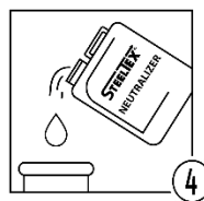
Шаг 4 - Нейтрализация кислотности теплообменника
