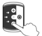
6. Работа только на вытяжку. При нажатии кнопки на три секунды приточный вентилятор отключится, индикатор скорости вентилятора будет мигать на соответствующей скорости. Для отключения режима нажмите и на три секунды.
