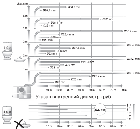
Рис. 55 Максимальная длина вертикальных и горизонтальных сливных труб
