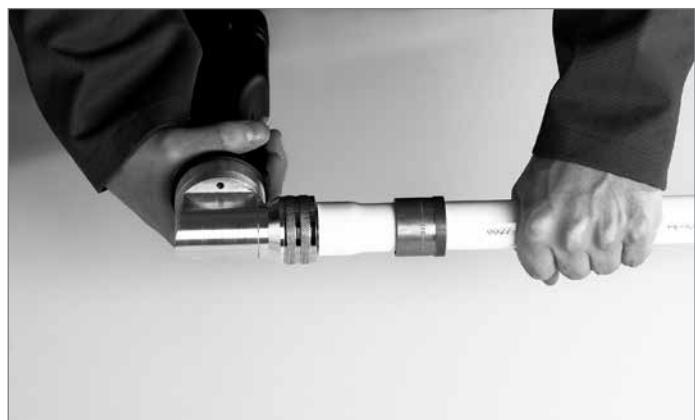
Выбрать расширительную насадку в соответствии с диаметром трубы и навинтить на расширительный инструмент RazFaz. После этого до упора насадить конец трубы на расширительную насадку и выполнить расширение с помощью пресс-инструмента. Инструмент необходимо держать непосредственно перед концом трубы.
