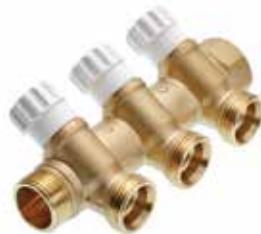
Гребенка с запорными вентилями для водоснабжения. Присоединение – 3/4", внутренняя и наружная резьбы; Выводы – 3/4", Евроконус; Необходимые для подключения к выводам разборные концовки поставляются отдельно.
