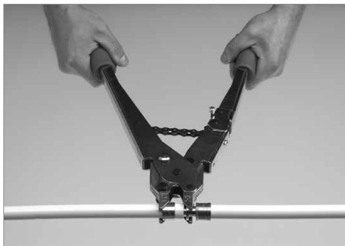
Выбрать вилкообразные насадки с маркировкой соответствующей диаметру трубы и с помощью штифтов зафиксировать насадки на ручном пресс-инструменте. Насадить пресс-втулку рукой как можно ближе к концу трубы, поместить фитинг и втулку в вилкообразные насадки. С помощью пресс-инструмента запрессовать втулку до фитинга. Зазор, оставшийся между фитингом и втулкой (приблизительно 0,5 мм), является характерным и несущественным.
