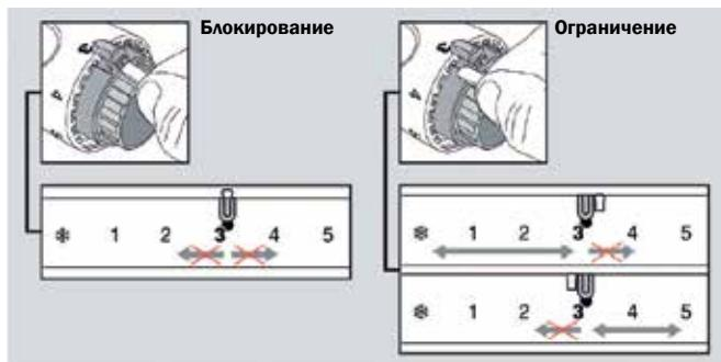
Комнатные температуры соответствуют цифрам на шкале терmostата согласно вышеприведенной шкале. Эти цифры являются контрольными, так как на реальные комнатные температуры часто влияют условия установки.
