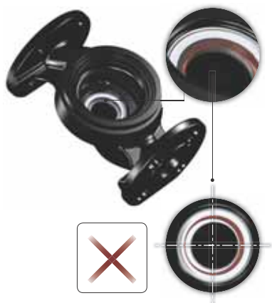
Рис. 14 Неправильно выровненная система уплотнений
