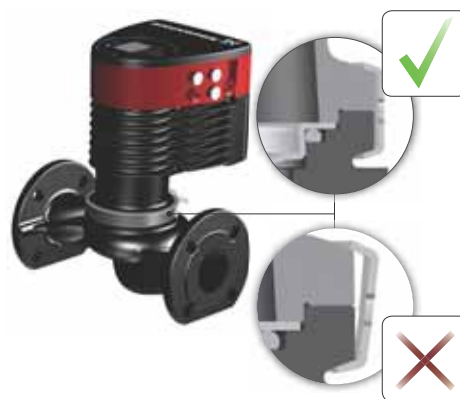
Рис. 15 Закрепление головной части насоса на корпусе насоса
