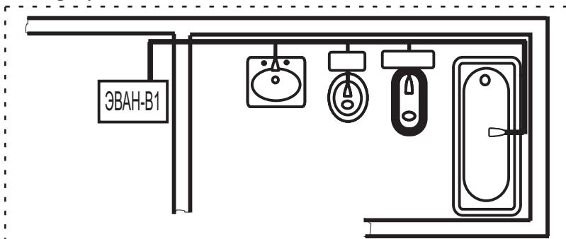
**Рисунок 4 - Принципиальная схема водопроводной сети.**
