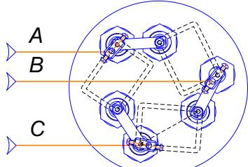
**Подключение секций мощностью 12, 18 кВт**
