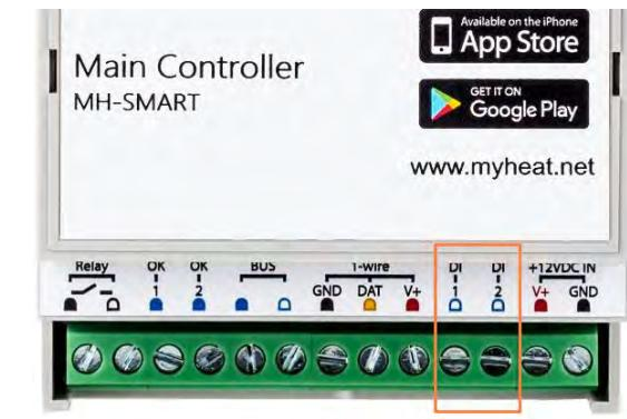
**DI 1, DI 2 – дискретный вход для оповещения от внешних устройств (ОПС, датчик протечки и т.д.)**
