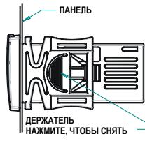
Контроллер XR75CX должен монтироваться на вертикальной панели в вырез 29x71мм и закрепляться, используя поставляемые специальные держатели. Диапазон температур, разрешенный для правильной эксплуатации - 0-60°C. Избегайте мест, подверженных сильной вибрации, с присутствием агрессивных газов, чрезмерной запыленностью или влажностью. Те же рекомендации применяйте и к датчикам. Позвольте воздуху циркулировать через отверстия для охлаждения.
