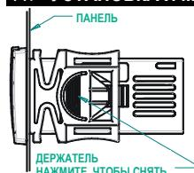
Контроллер XR60CX должен монтироваться на вертикальной панели в вырез 29x71мм и закрепляться, используя поставляемые специальные держатели.
