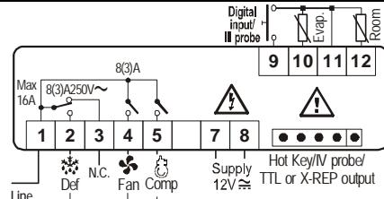
ПРИМЕЧАНИЕ: В соответствии с моделью реле компрессора - 8(3)A или 16(6)A.
