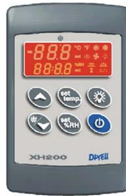
set temp. Отображение и изменение значения требуемой уставки температуры (SET\_TEMP).
