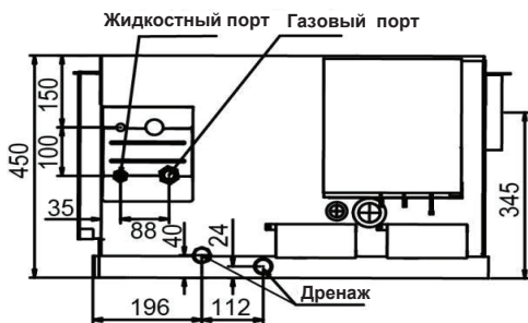
Вид трубопроводов с боковой стороны
