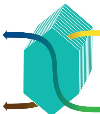
Алюминиевые и пластиковые противоточные теплообменники передают тепло (ощущимое тепло) и могут достичь КПД более 90%.
