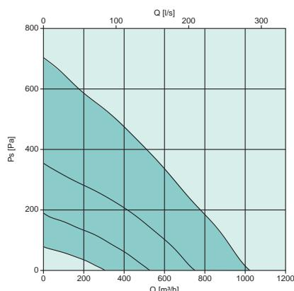
SAVE VTC 700 - это высокоэффективный приточно-вытяжной агрегат с алюминиевым противоточным теплообменником и верхним типом подключения. Разработан для напольного монтажа в прачечных, кладовых и т. д. в домах с вентилируемой площадью до 550 м<sup>2</sup>. Класс энергоэффективности A+ доступен вместе с внешними аксессуарами контроля качества воздуха.
