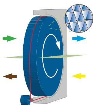
Помимо тепла (ощущимое тепло), роторные теплообменники также способны передавать влагу (скрытое тепло). Применяются в коттеджах и квартирах, обеспечивают КПД рекуперации более 85%.
