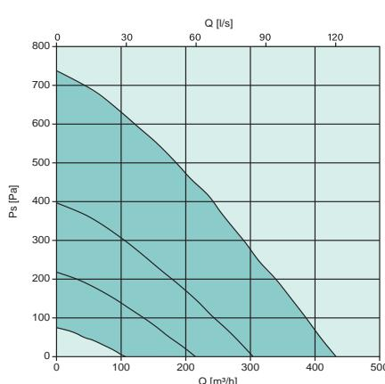
SAVE VSR 300 – приточно-вытяжной агрегат с боковым подключением воздуховодов, с высокоэффективным бесступенчатым роторным теплообменником, с байпасом для вытяжки. Разработан для монтажа на чердаке или в подпотолочном пространстве в домах с вентилируемой площадью до 240 м<sup>2</sup>.
