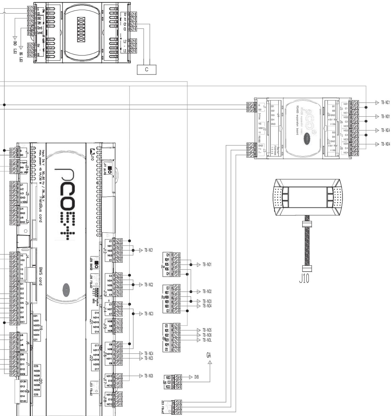
12.5 Электрическая схема насосного агрегата humiFog multizona – Slave – CE
