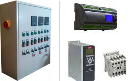
Щит управления предназначен для сбора информации от контролирующих устройств, контроля производительности установки и координации работы исполнительных элементов установки (привод вентилятора, секции нагрева и охлаждения, задвижки).
