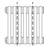
**21-40 секций – 3 линии крепежа / 6 точек крепления / 3 ножки**
