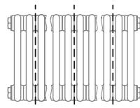
**41-60 секций – 4 линии крепежа / 8 точек крепления / 4 ножки**
