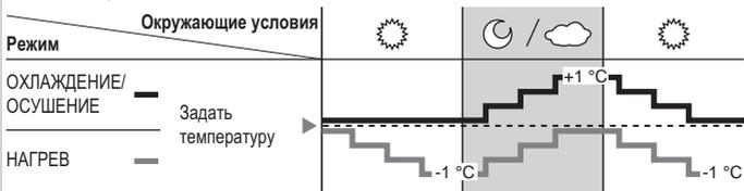
Включена функция **ECONAVI**, блок поддерживает заданную температуру, пока не повысится интенсивность солнечного света. Определенная датчиком солнечного света интенсивность солнечного света при изменениях погоды или смене дня/ночи используется при регулировании температуры.
