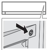
Используется, когда пульт дистанционного управления не соответствует или работает неисправно. Поднимите переднюю панель:
