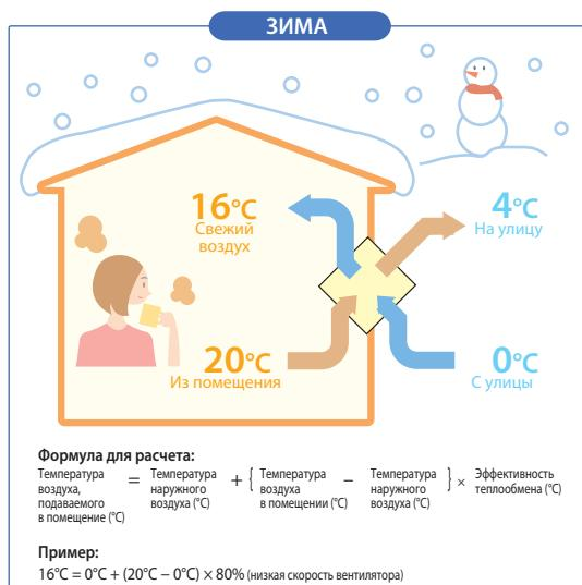
$$\text{Формула для расчета:} \\ \text{Температура воздуха, подаваемого в помещение (°C)} = \text{Температура наружного воздуха (°C)} - \left\{ \frac{\text{Температура наружного воздуха (°C)} - \text{Температура воздуха в помещении (°C)}}{\times \text{Эффективность теплообмена (°C)}} \right\}$$
