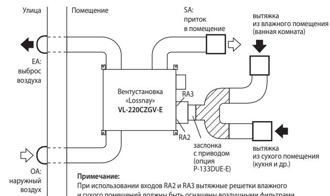
**Примечание:** При использовании входов RA2 и RA3 вытяжные решетки влажного и сухого помещений должны быть оснащены влагозащитными фильтрами.
