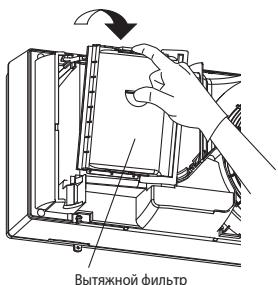
Фильтр вытяжного воздуха можно почистить пылесосом и протереть влажной тканью.
