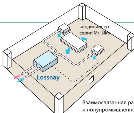
Взаимосвязанная работа вентустановки Lossnay и полупромышленного кондиционера
