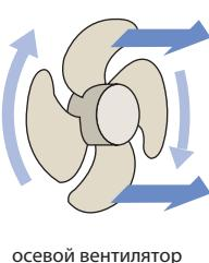
Осевые вентиляторы имеют низкое статическое давление, и их способность удалять воздух из герметизированных помещений ограничена. Также они не могут быть использованы для работы с сетью воздуховодов и дополнительных вентиляционных элементов.
