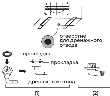
**Примечание:** изображение конструкции дренажного патрубка приведено для справки. Конструкция дренажного патрубка вашего кондиционера может отличаться (например, может отсутствовать резиновая прокладка).
