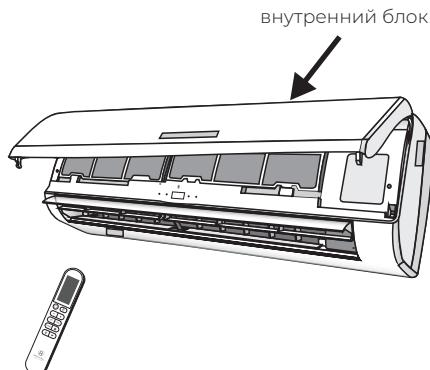
2. Регулирование направления потока с помощью горизонтальных жалюзи (вверх-вниз)
