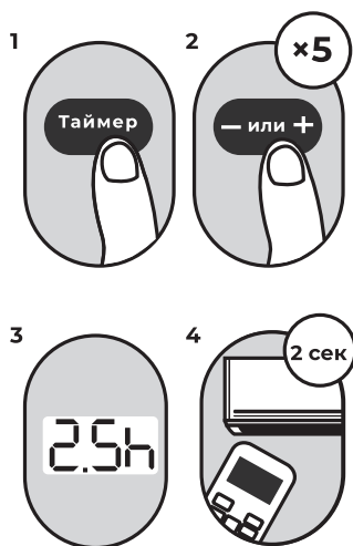
Пример: установка таймера на включение блока через 2,5 часа.
